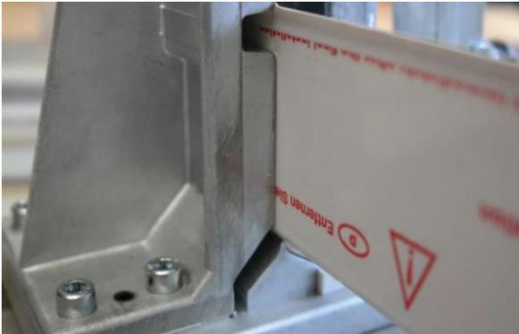
**1** Das Profil umdrehen und mit der Dachfläche gerade auflegen, Spanner schließen und langsam stanzen.
